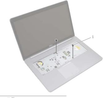
1 viti (2) **2** Capovolgere il computer e ricollocare le viti che fissano il coperchio centrale alla base del computer.
